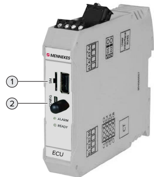
Obr. 19: Přípojky na jednotce ECU
